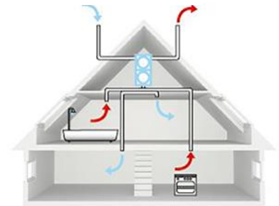
Mechanische Belüftung: Ausgewogene zentrale Zufuhr und Abluftversorgung
