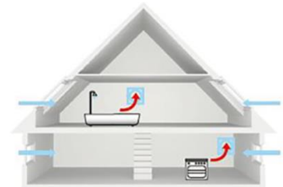
Mechanische Belüftung: Dezentraler Auszug
