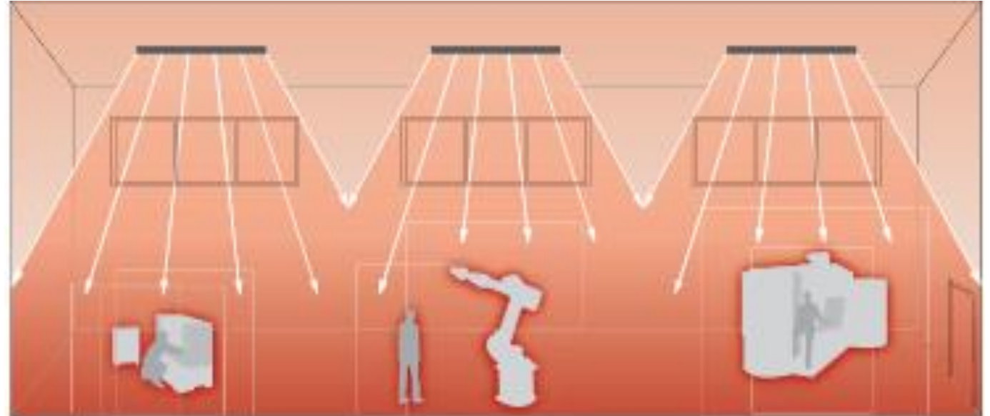
Kuva 16: Kattolämmityslautojen säteilyä, lähde: Arbonia (2018)
