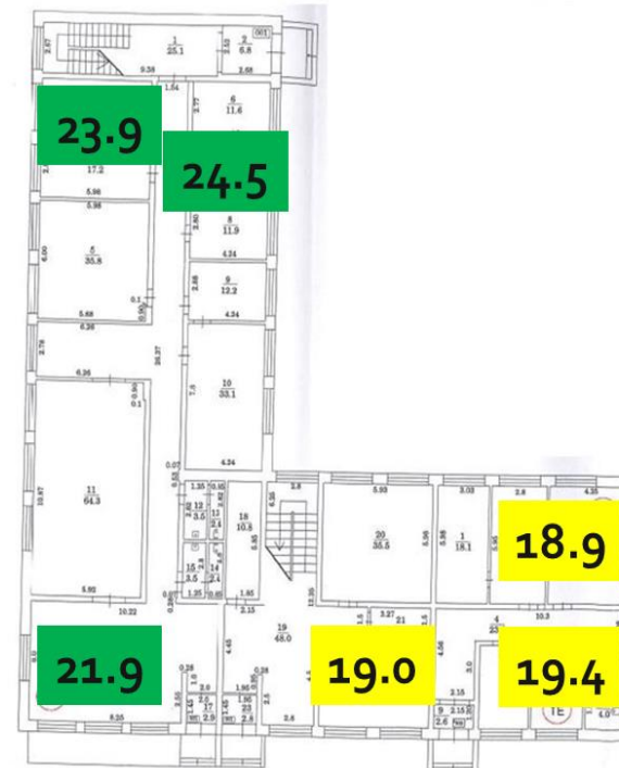
Kuva 26 –sisäilman lämpötilan jakautuminen julkisessa rakennuksessa. Lähde: V. Kirsanovs (Riian teknillinen yliopisto)
