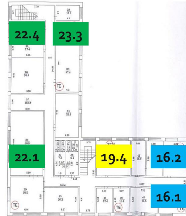
Kuva 26 –sisäilman lämpötilan jakautuminen julkisessa rakennuksessa. Lähde: V. Kirsanovs (Riian teknillinen yliopisto)
