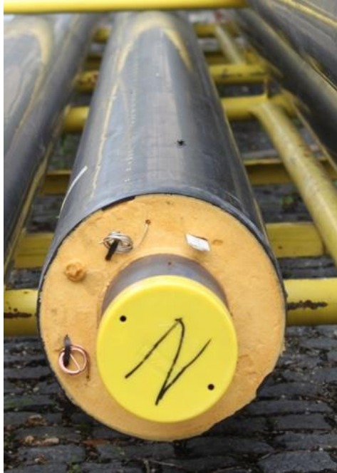
Muoviputki, jossa on teräksinen sisäputki (Lähde: D. Rutz) [3]
