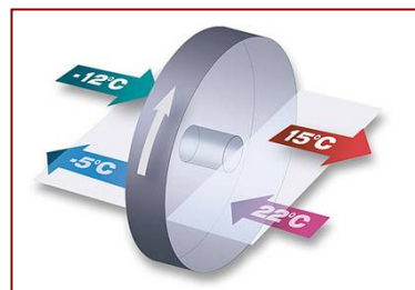
Masa akumulacyjna obrotowego wymiennika ciepła
