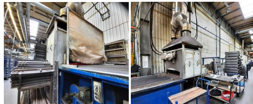
Вид загрузочной и выходной частей паяльной печи № 1 Sources: TERMA Sp. z o.o. Photo:D. Formela
