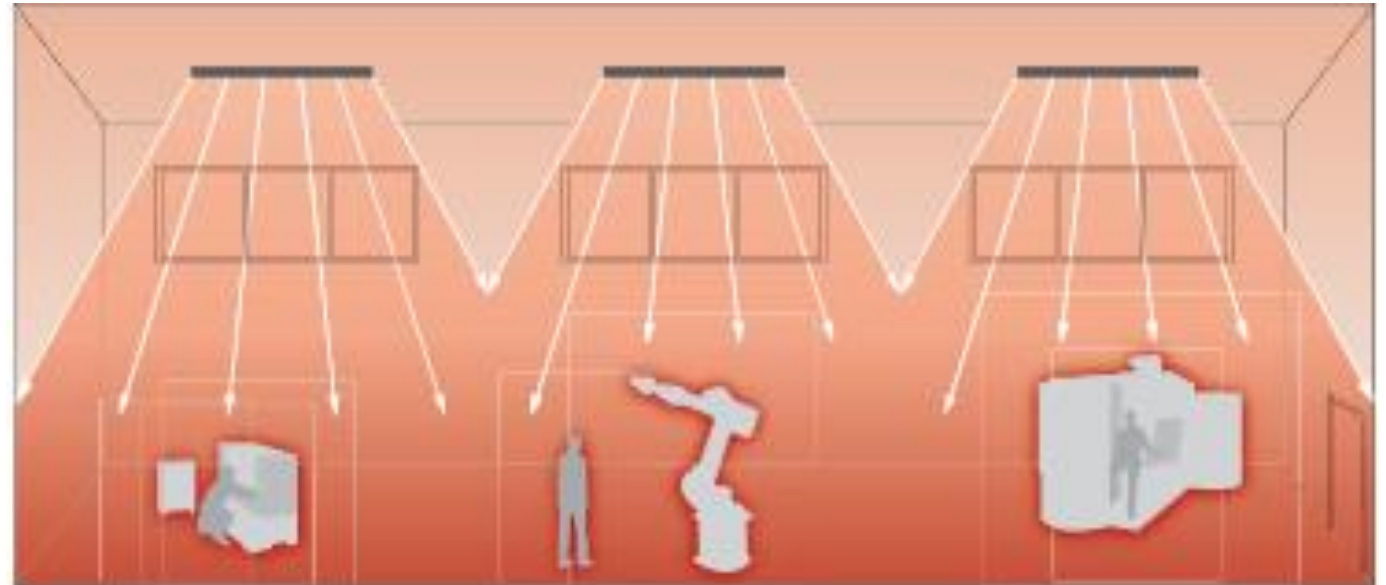
16 pav.: Šildančių lubų plokščių radiacija, šaltinis: Arbonia [13]
