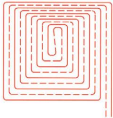
9 pav.: Klojimas sraigės forma, šaltinis: Rehau AG + Co [8]
