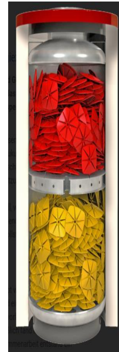
Рис 8: Heat cells – тепловые ячейки (материал с фазовым переходом) в теплоизолированном хранилище (слева) и здание Futurium в Берлине (справа) source: www.em-power.eu
