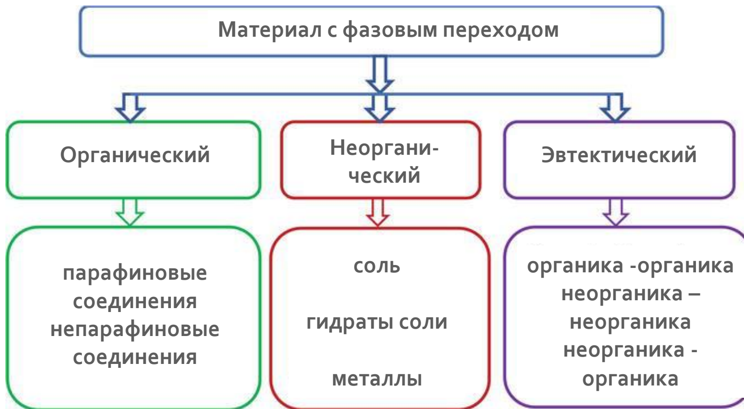
Рис 6: Различающиеся характеристики хранилищ из материалов с фазовым переходом, source: Getu Hailu (2018)
